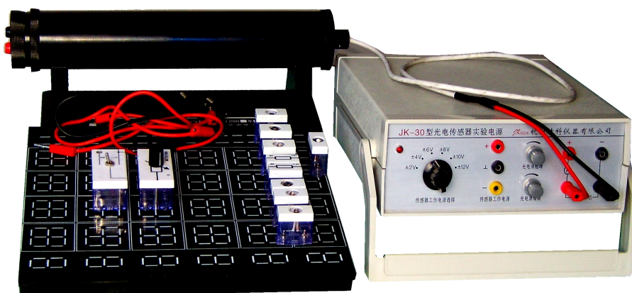
图 1a 光电传感器实验仪
